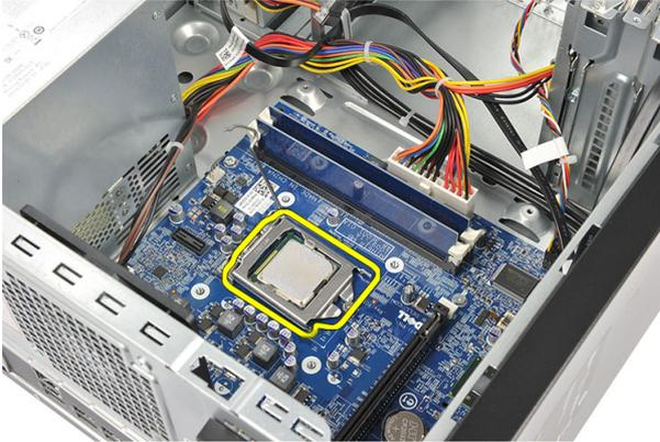
8. Angkat prosesor untuk melepaskannya dari soket dan tempatkan dalam kemasan antistatis.
